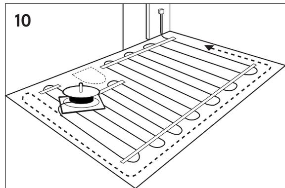
(Bild 11A+B) Om du måste passera förbi anslutningskabeln för att komma till ett tomt ytterspår: Skär bort 20 mm av isolerplattan längs med väggen, ändra ner till betonggolvet och passera med värmekabeln där.
