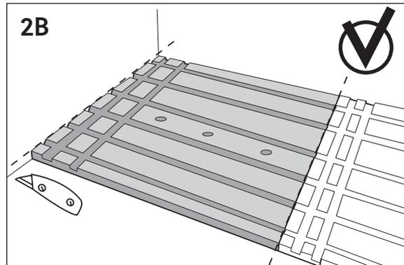
(Bild 3) Skär ut ett spår för spiralslangen till golvvärmevärmestatsens givare. Skär sedan ut en fyrkant 10x30 cm, men endast 1 cm djup. Här ska sedan givaren placeras.
