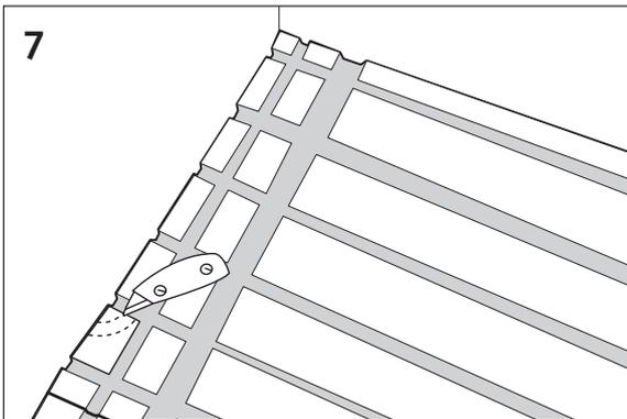
(Bild 8) Lägg anslutningskabeln i spåret och fortsätt till närmsta hörn. Fäst med tejp intill det breda spåret på skivans kortsida och låt tejprollen sitta kvar. Lägg kabeln i det näst yttersta spåret och fortsätt mot motsatt vägg.
