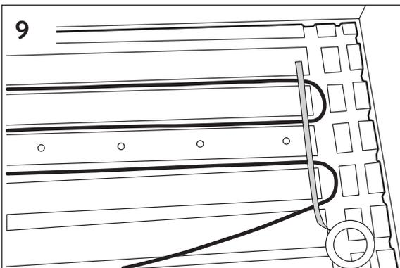
(Bild 10) Om du får kabel över när alla spår är fyllda. Lägg den i tomma ytterspår, i första hand mot ytterväggar.
