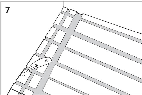
(Kuva 8) Aseta kytkentäkaapeli uraan ja jatka lähimpään kulmaan. Kiinnitä teipillä levyn lyhyen sivun leveään uraan asti ja jätä teippiirulla kiinni. Aseta kaapeli seuraavaksi uloimpaan uraan ja jatka kohti vastakkaista seinää.
