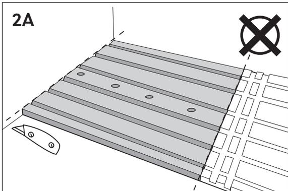
Våtrom Cable Board legges ikke i dusjsjonen der fall skal sparkles mot sluket. Vi anbefaler i stedet Ebeco Thermo Board (8960160) for dette arealet. Monter Thermo Board ifølge den medfølgende anvisningen. Kabelen legges ifølge instruksjonene rett mot Thermo Board-platen.
