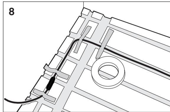
(Bild 9) Vänd i det näst yttersta, breda spåret på skivans kortsida. Tejpa direkt innanför det breda spåret och låt tejprollen sitta kvar. Fortsätt likadant tills kabeln tar slut och alla spår utom ytterspårerna är fyllda.
