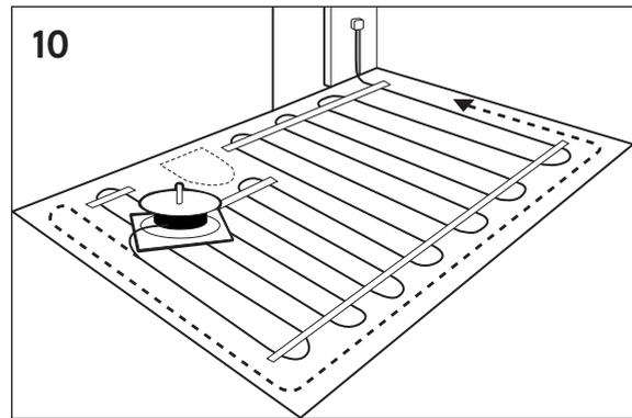
(Kuva 11A+B) Jos joudut ohittamaan kytkentäkaapelin päästäksesi tyhjiin reunauraan: Leikkaa pois 20 mm eristyslevyä seinän vierestä aina betonilattiaan asti ja tee ohitus lämmityskaapelilla siellä.
