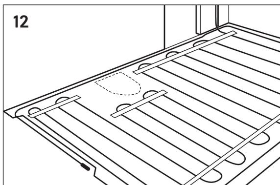
(Bild 13) Tejpa nya tejpremsor parallellt med de första tejpremsorna, ca 6 remsor/meter.
